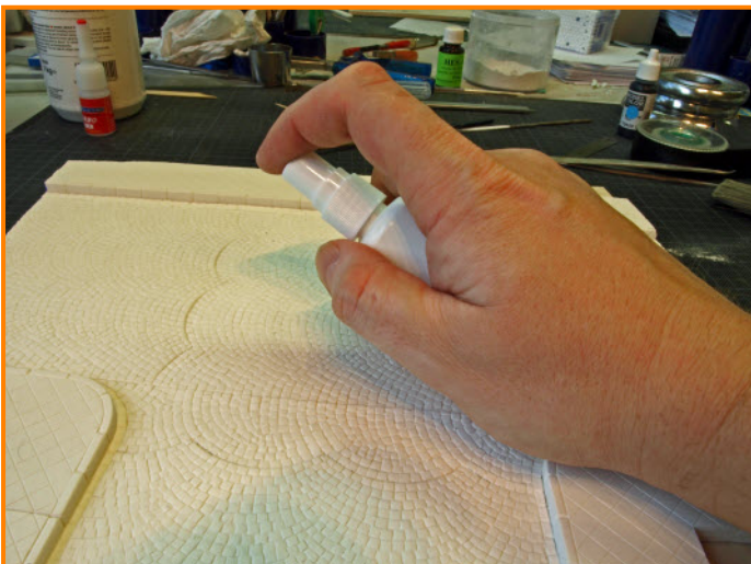
Wenn das Gipspulver schön in den Fugen liegt und die übrigen Flächen gesäubert sind wird entspanntes Wasser (durch ein Tröpfchen Agepon oder Spüli) aus einem Pumpzerstäuber aufgesprüht. Erst vorsichtiger, damit kein Gips fortgespült wird, danach tiefend nass.
