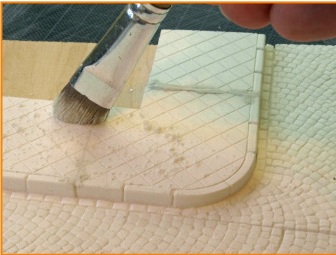
Der überflüssige Gips wird durch den Wasserzug des Gipsmaterials bröselig und kann vor dem entgültigen Aushärten leicht mit einem festen Borstenpinsel abgebürstet werden.
